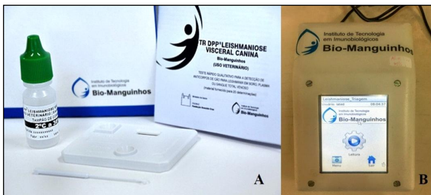
Figura 4. Kit TR DPP® para Leishmania Visceral Canina. Plataforma plástica com dois poços por onde são conduzidas amostra e solução tampão, ocorrendo a reação (A). Equipamento utilizado para leitura do teste rápido (B). (Fonte: Arquivo pessoal)) Fonte:
