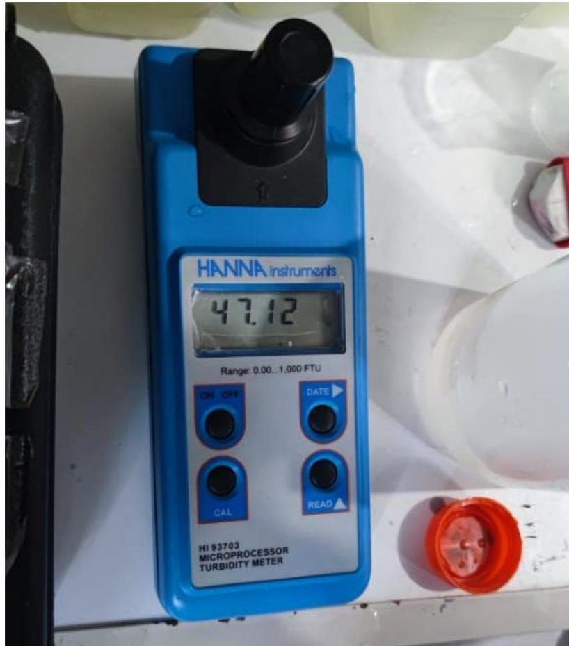
Figura 49 - Turbidímetro da marca Hanna Instruments de faixa 0 a 1000 NTU
