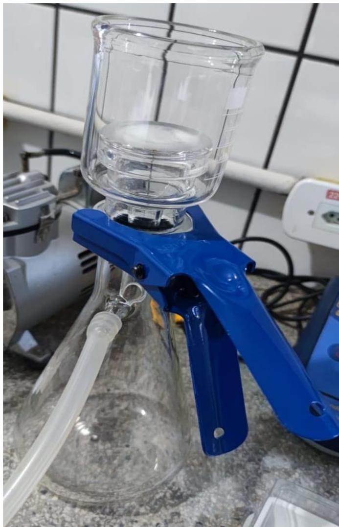
Figura 39 - Funil de Büchner de vidro, garra metálica e Kitassato
