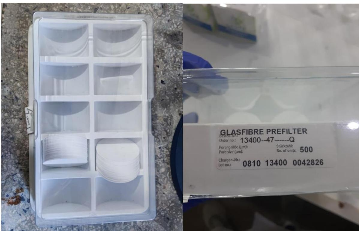
Figura 43 - Membrana de filtração de fibra de vidro
