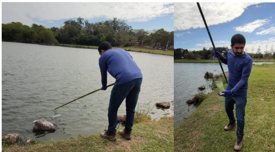
Figura 34 - Vara de bambu e Nylon
