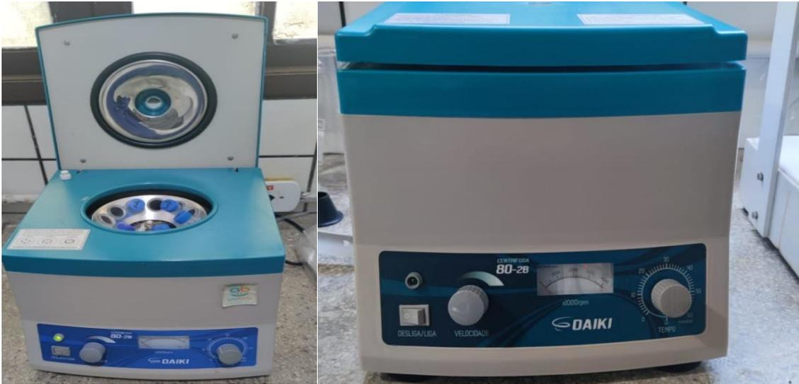
Figura 47 - Centrífuga clínica 80-2B com rotor de ângulo fixo com velocidade regulável até 4000rpm
