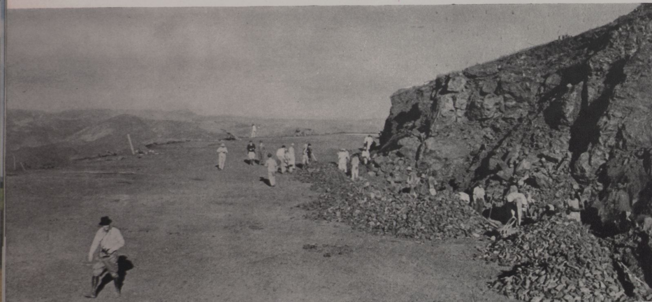
A mina de Itabira é uma montanha de minério quasi sólido, cujo teor de óxido de ferro é de 68,5 por cento — um dos maiores teores dentre todos os depósitos conhecidos. Perto do tope da montanha de quasi 2.000 metros de altura, o minério está sendo extraído e transportado, por caminhões, para a via férrea construída no vale do Rio Doce.
