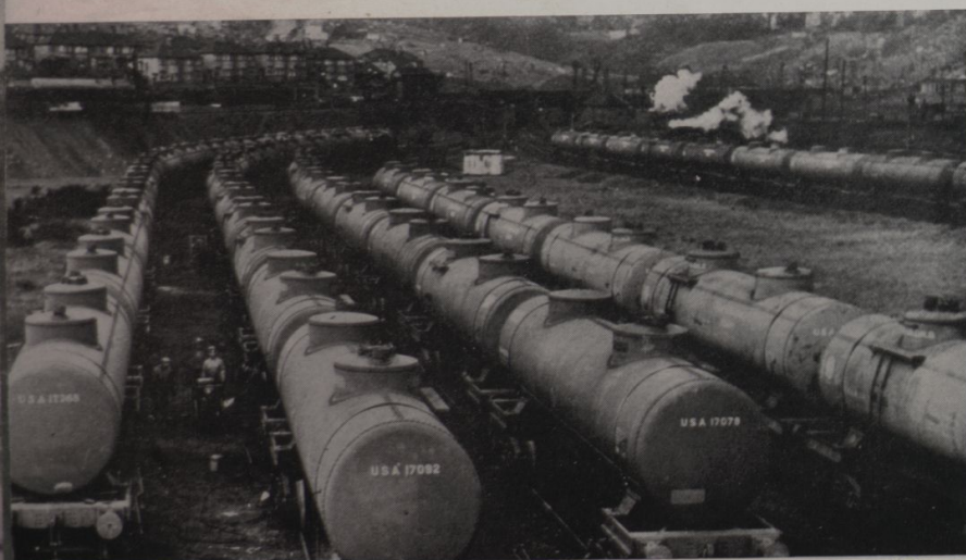
Vagões de gasóleos, construídos de acordo com a bitola usada na Europa, prontos para serem conduzidos para o outro lado do Canal da Mancha, afim de abastecer as tropas invasoras. Os vagões foram construídos nos EE.UU.
