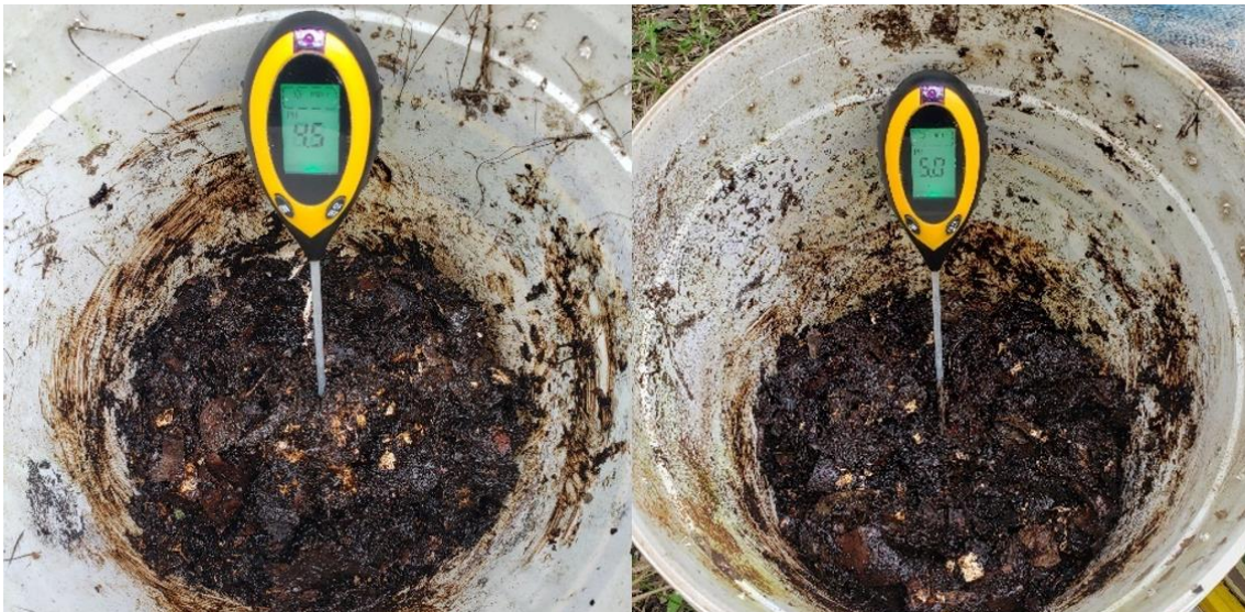
Figura 79: Medição de pH do produto compostado indicando faixas ácidas. (Fonte: A autora).
