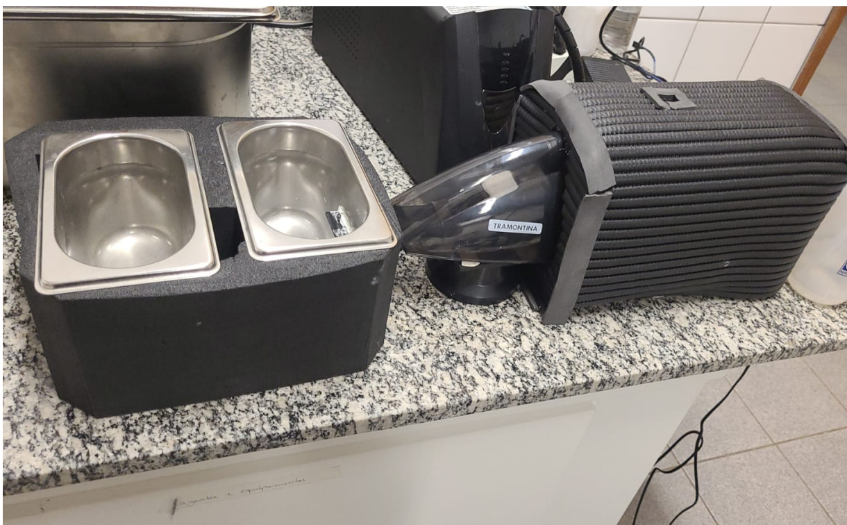
E-nose 1 - Sistema de sucção com suporte duplo (1) amostra (2) headspace de sucção.
