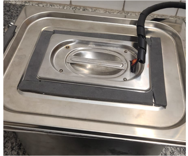
E-nose 1 Camara de sensores para amostras maiores (exemplo melão) com a tampa contendo os sensores
