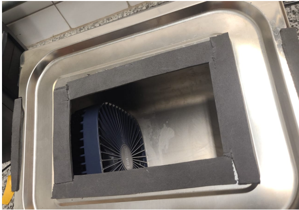
E-nose 1 Camara de sensores para amostras maiores (exemplo melão)
