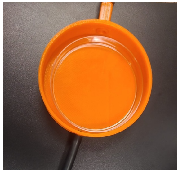
E-nose 2 camara da amostra para produtos em pó/grãos
