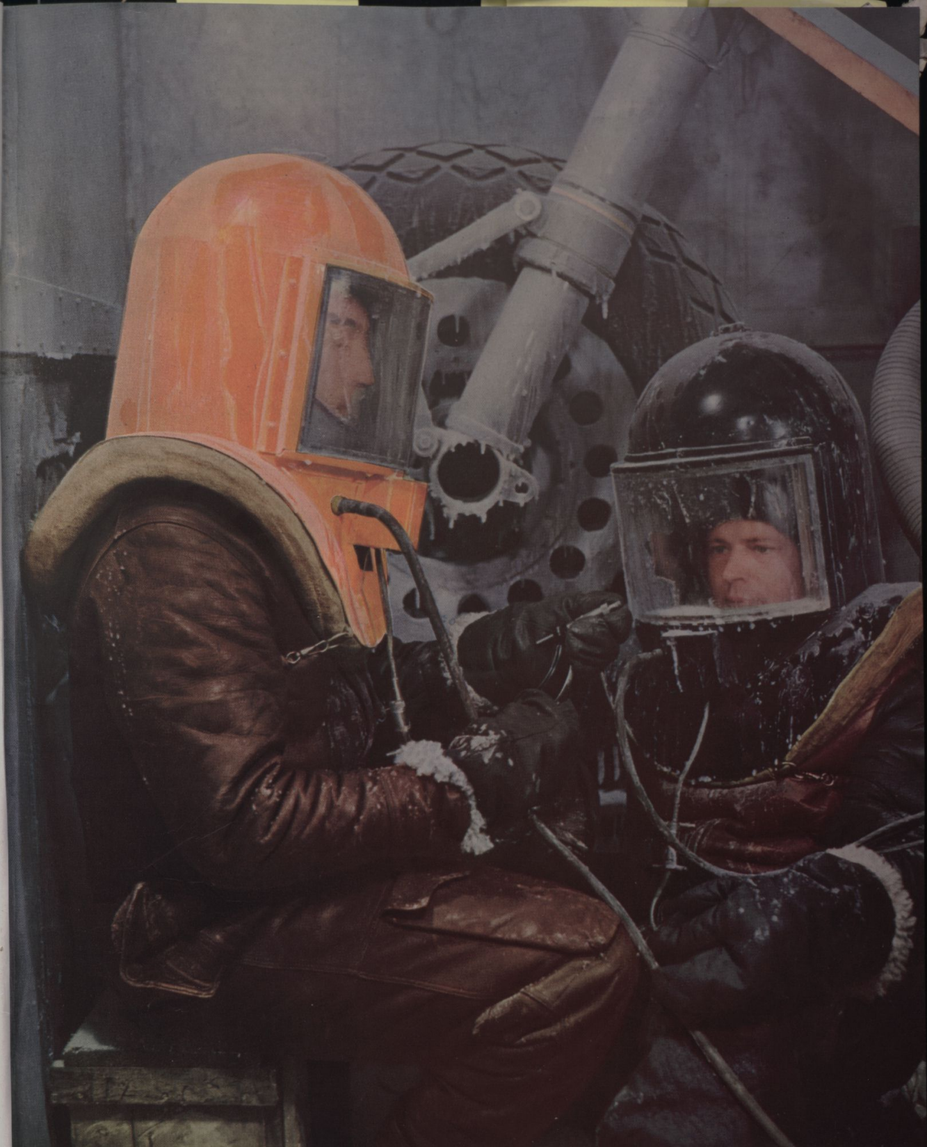
Técnicos especialistas, vestidos fantásticamente, entregam-se a importantes pesquisas, pondo à prova os materiais de aviões, dentro duma câmara onde a temperatura chega a 37,8 graus abaixo de zero. Essa é a temperatura nos vôos a grandes altitudes, um dos problemas a serem solvidos para o desenvolvimento futuro da aviação
