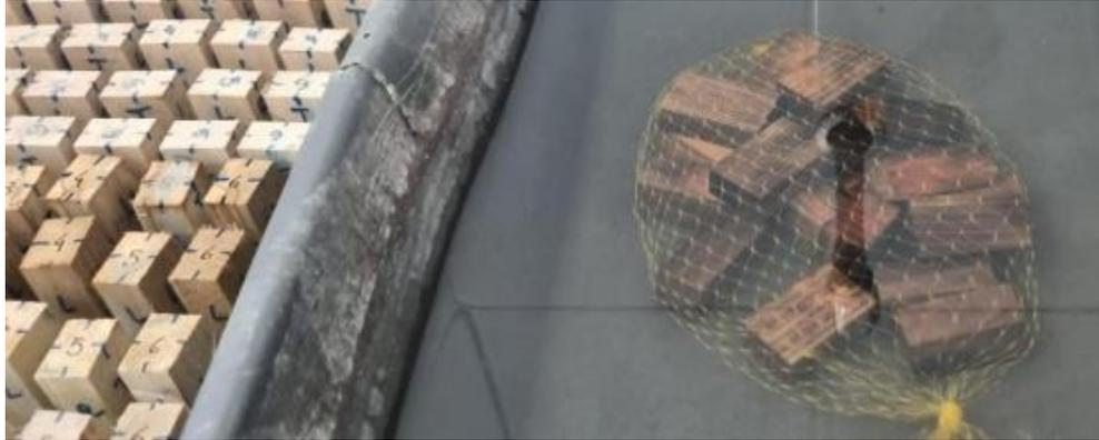
**Figura 11.** Corpos de prova de propriedades físicas em submersão em água para saturação (a direita). Fonte: Autor, 2024.
