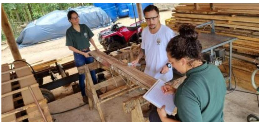
**Figura 7.** Mensuração dos volumes das pranchas e tábuas serradas após secagem (comprimento, largura e espessura). Fonte: Autor, 2024.
