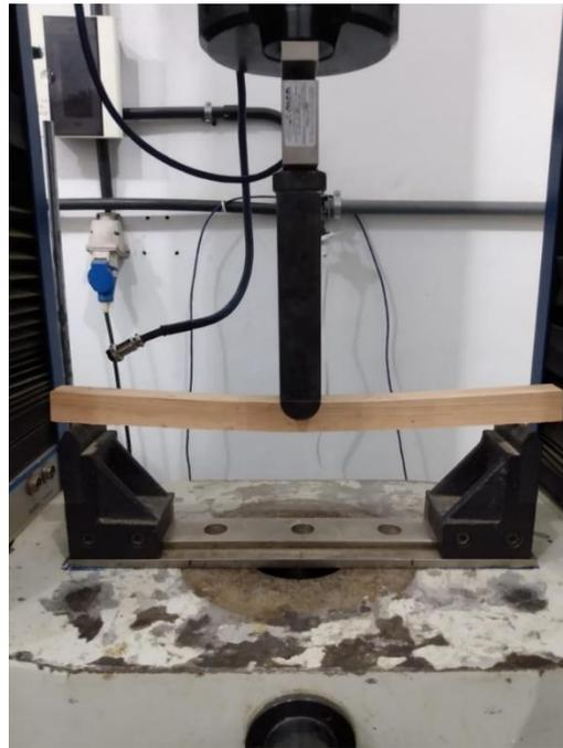
**Figura 10.** Ensaio de flexão estática. Fonte: Autoria própria (2024).
