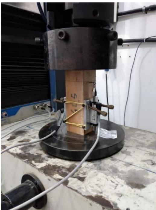
**Figura 13.** Ensaio de compressão paralela às fibras com uso dos extensômetros. Fonte: A autoria própria (2024).
