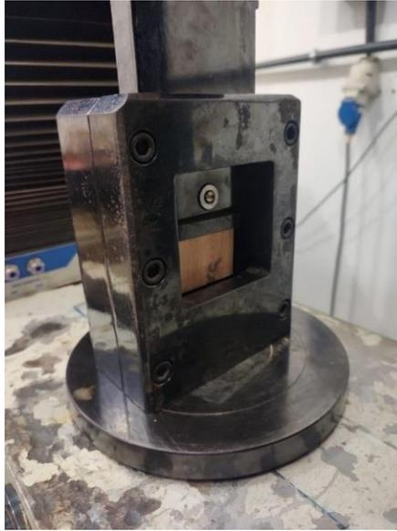
**Figura 8.** Detalhe de ensaio de cisalhamento paralelo às fibras. Fonte: Autoria própria (2024).
