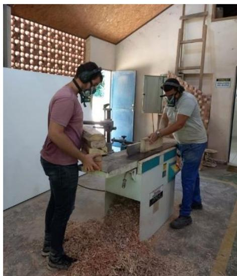
**Figura 3.** Início da produção dos corpos de provas a partir da sub-amostra, utilizando a plaina desempenadeira. Fonte: Autoria própria (2024).
