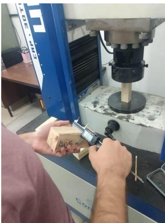
**Figura 5.** Medição de corpo de prova com paquímetro digital. Fonte: Autoria própria (2024).
