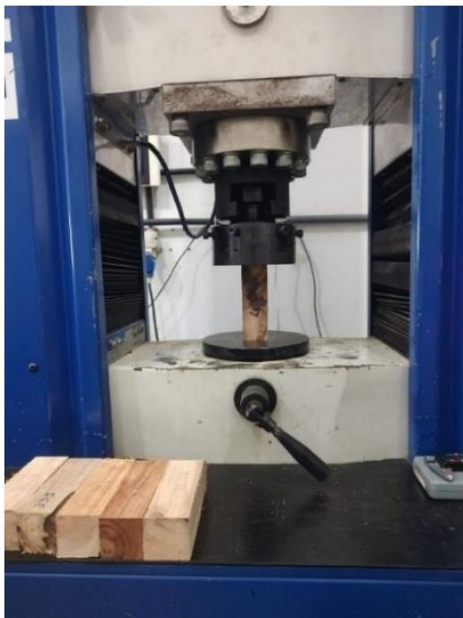
**Figura 12.** Ensaio de compressão paralela às fibras sem uso de extensômetros. Fonte: A autoria própria (2024).
