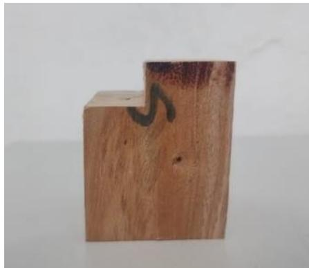
**Figura 7.** Corpo de prova de ensaio de cisalhamento visto lateralmente. Fonte: Autoria própria (2024).
