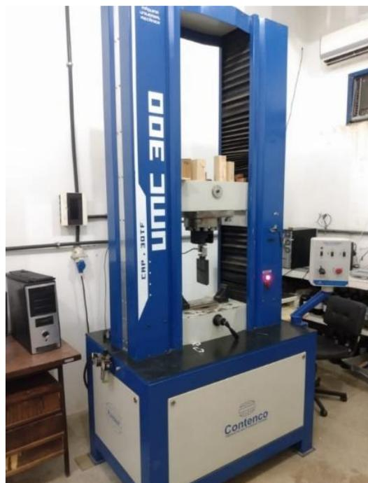
**Figura 4.** Máquina de ensaios Contenco UMC-300. Fonte: Autoria própria (2024).
