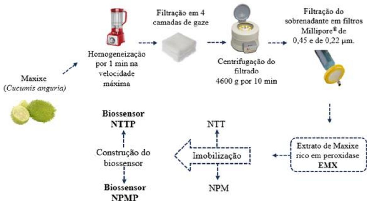
**Figura 18.** Etapas de obtenção dos Biossensores NTTP e NPMP.
