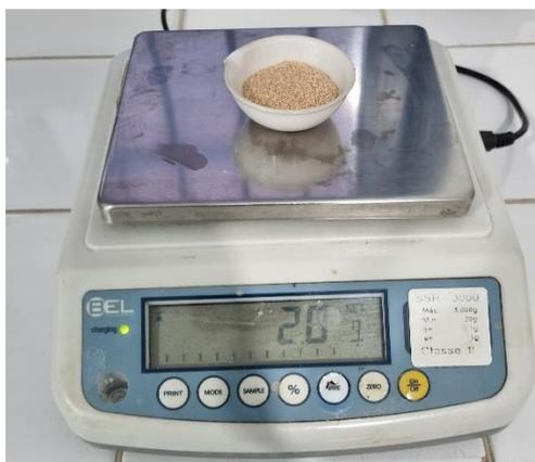
**Figura 3** – Pesagem das amostras de serragens em cadinho de porcelana.
