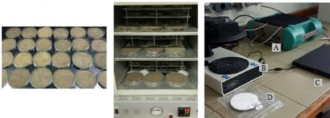
Figura 9. Da esquerda para a direita: amostras de TFSA colocadas e niveladas em placas de Petri; estufa; conjunto de equipamentos necessários às leituras espectrais, sendo A- espectrorradiômetro Field Spec 4; B- disco-mesa giratória suporte para as placas de Petri; C- computador acoplado ao espectrorradiômetro e D - placa de spectralon.
