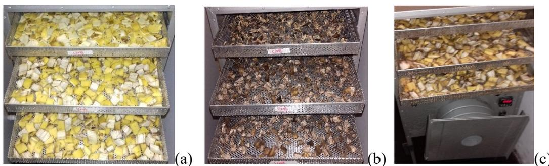
**Figura 2.** Representação do processo de secagem com as cascas úmidas (a) e já secas dispersas nas bandejas (b), bem como do secador de bandejas em funcionamento, com a tampa ainda aberta (c).
