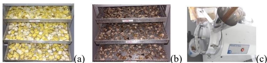
**Figura 1.** Representação da secagem com as cascas úmidas (a) e já secas (b) no secador de bandejas e a posterior trituração em moinho de facas (c)
