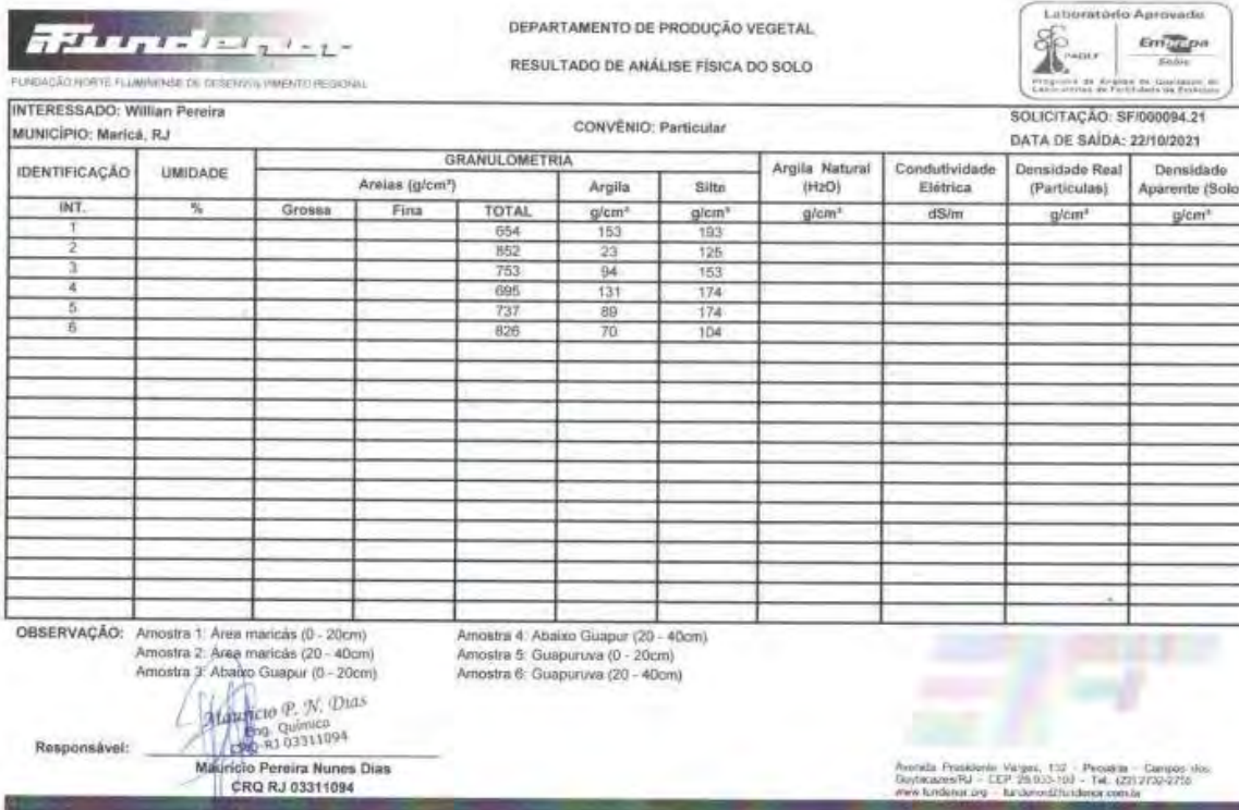
Figura 6. Análise granulométrica de amostras de solo da área do Horto da Agrobiodiversidade
