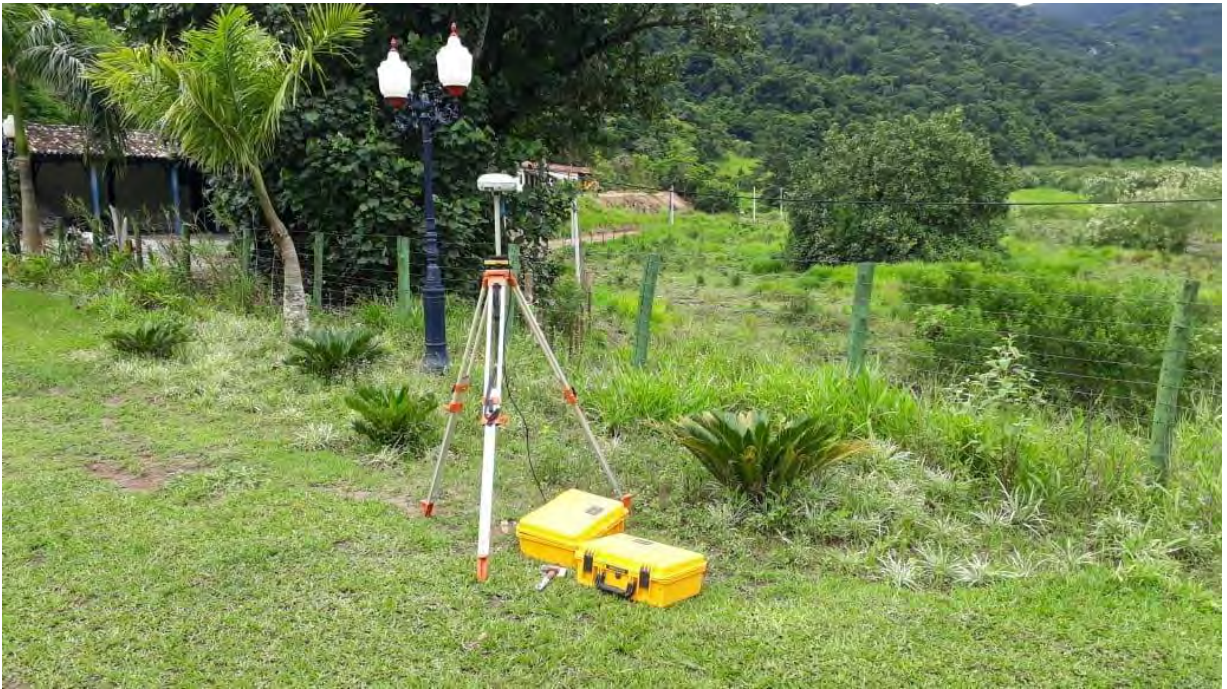
Figura 1. Equipamento topográfico RTK associado ao Drone para levantamento topográfico e aerofotometria.
