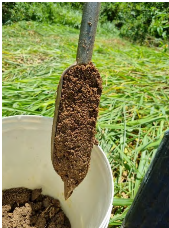
Figura 8. Coleta de solos realizada de 0 a 20 cm e 20 a 40 cm de profundidade nas glebas de produção do Horto da Agrobiodiversidade.
