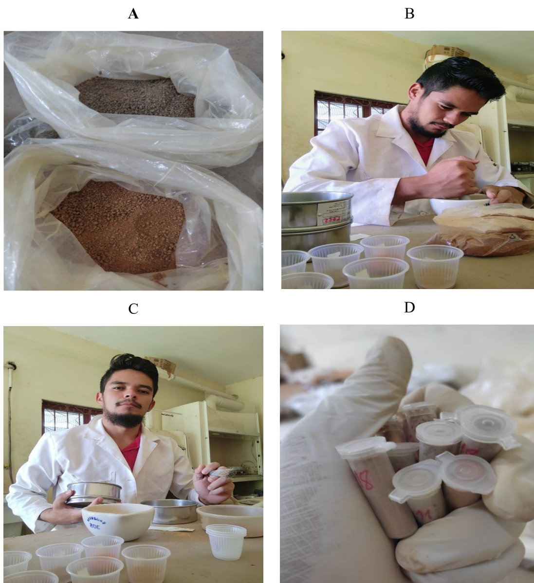
Figura 14. Procedimento para obtenção das amostras de terra para análise dos teores de carbono total e nitrogênio total pelo método de combustão a seco. Fonte: O autor.
