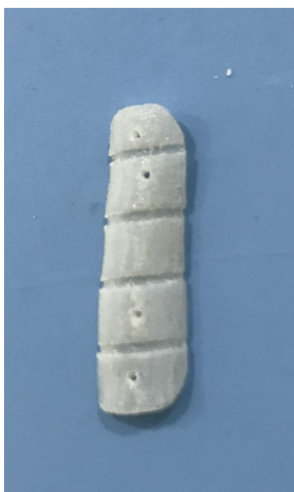
Figura 8: Implante para correção de fratura umeral de gavião-carijó ( Rupornis magnirostris ) confeccionado em policaprolactona sendo perfurado com pino de Schanz de 0,8 mm.
