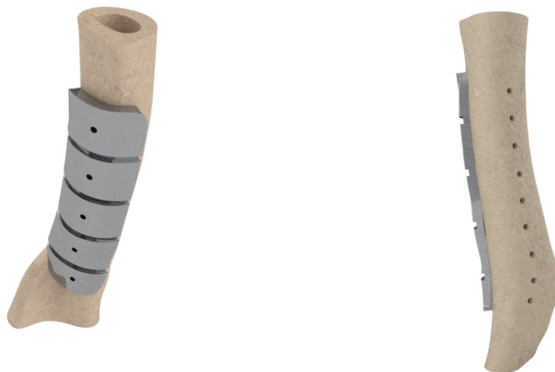
Figura 2: Imagem renderizada de conjunto placa-osso para ser utilizado em teste computacional pelo Método de Elementos Finitos (MEF) na validação de placa para osteossíntese de região distal de úmero planejada a partir de tomografias computadorizadas de cadáveres de gavião-carijó ( Rupornis magnirostris ).
