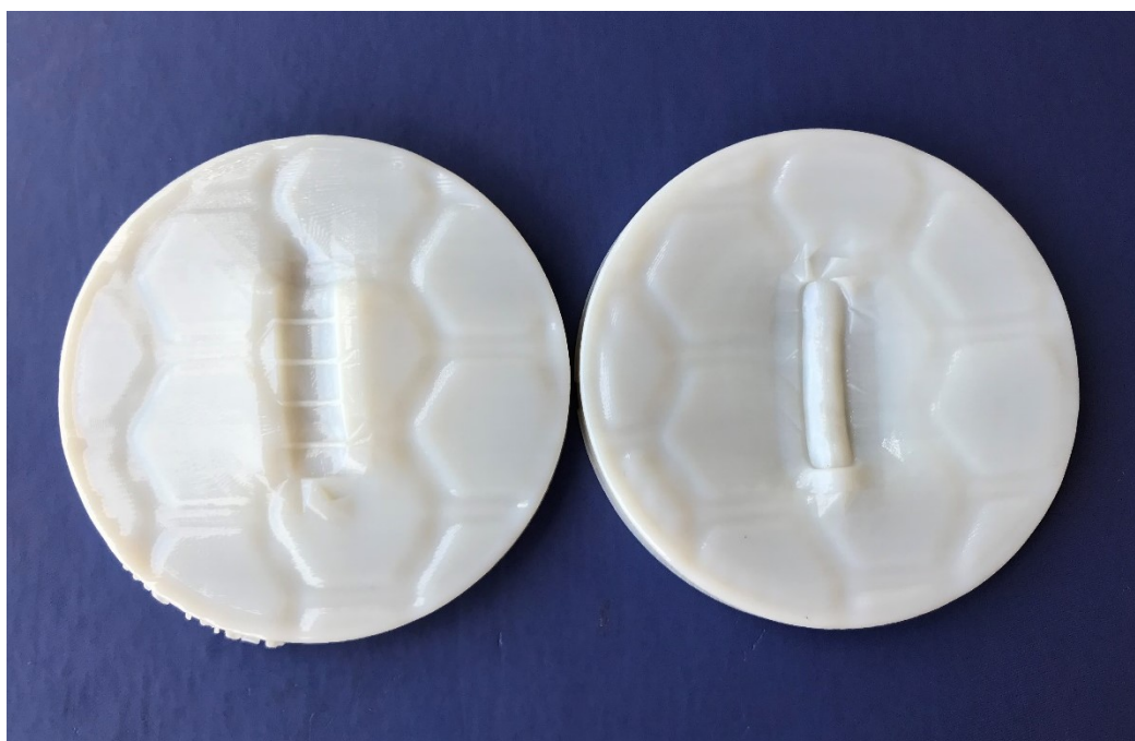
Figura 25: Molde bipartido impresso por manufatura aditiva em material VeroWhite para confecção de placa de osteossíntese em PCL pelo método de prensagem manual.
