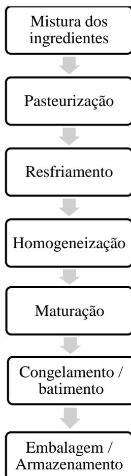
**Figura 3.** Fluxograma da fabricação de sorvete.
