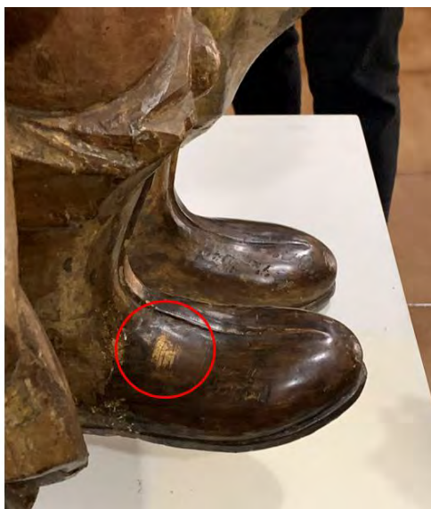
Figura 85. Pormenor da parte a ser analisada por Espectro de XRF, na região com vestígios de douramento na bota da escultura do Rei Davi. Duque de Caxias/RJ. Fonte: Elaine Gusmão, 2021.
