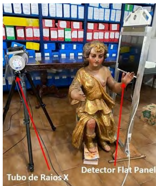
Figura 102: Equipamento utilizado para o exame de radiografia digital, escultura de Betsabá. Duque de Caxias/RJ. Fonte: Elaine Gusmão, 2022.
