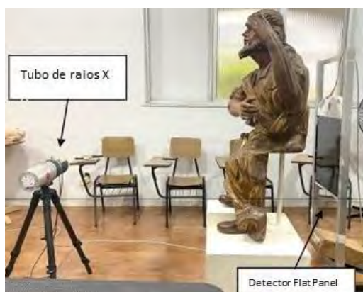
Figura 122. Equipamento utilizado para o exame de radiografia digital - escultura do Rei Davi, Duque de Caxias/RJ. Fonte: Elaine Gusmão, 2022.
