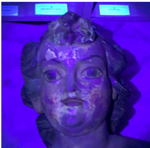
Figura 69. Pormenor do rosto da escultura de Betsabá, exame organoléptico com utilização de fotografia de fluorescência de ultravioleta (UV). Duque de Caxias/RJ. Fonte: Elaine Gusmão, 2022.
