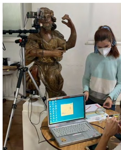
Figura 81. Análise com espectros de XRF na carnção da escultura do Rei Davi (2). Duque de Caxias/RJ. Fonte: Elaine Gusmão, 2021.
