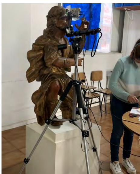
Figura 80. Análise com espectros de XRF na carnção da escultura do Rei Davi (1). Duque de Caxias/RJ. Fonte: Elaine Gusmão, 2021.
