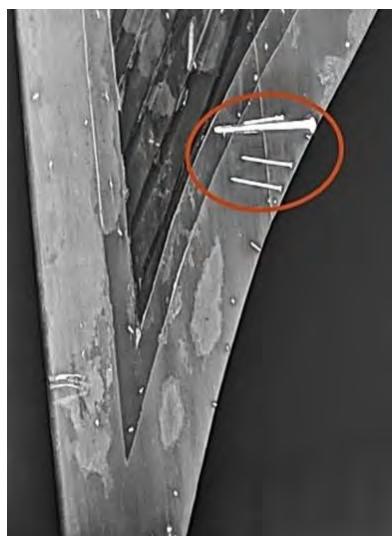
Figura 144. Radiografia digital da parte inferior da harpa, com detalhes dos pregos identificados e cravos metálicos. Duque de Caxias/RJ. Fonte: LIN/COPPE UFRJ, 2022.
