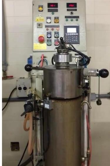
**Figura 05** - Equipamento de alta pressão hidrostática - Stansted Fluid Power.
