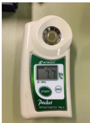
**Figura 09** - Refratômetro digital portátil (Atago®, modelo Pal-3 Co, Ltda., EUA).
