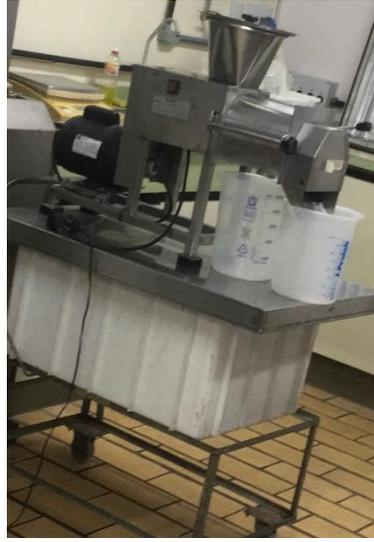
**Figura 01** – Despolpadeira marca: Itametal.
