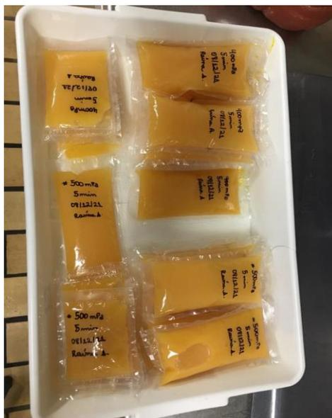
**Figura 03** - Suco misto de frutas submetido a alta pressão hidrostática.
