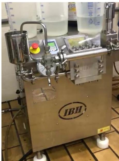
**Figura 04** - Homogeneizador a alta pressão.
