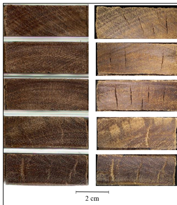
Figura 3: Corpos de prova de Corymbia citriodora modificados termicamente a 160°C antes (esquerda) e após (direita) o processo de interação com a água.
