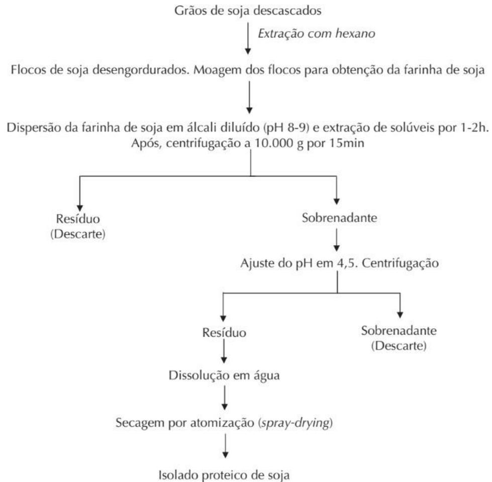
Figura 6. Processo para o isolamento da proteína de soja a partir da farinha de soja. Adaptado Fennema et al., 2010.
