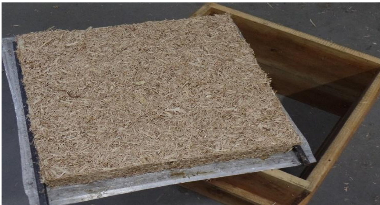
Figura 5 - Colchão de partículas após acomodação na caixa formadora sobre a na chapa de alumínio, pronta para prensagem em alta temperatura e pressão.
