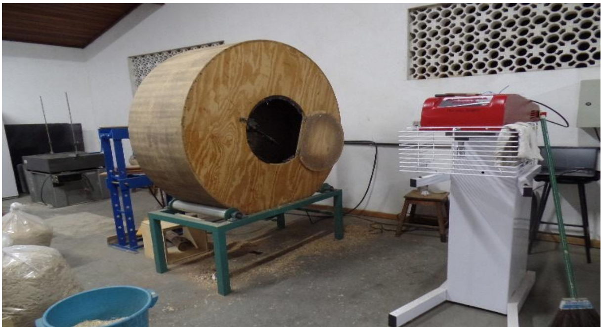
Figura 4 - Encoladeira utilizada para o processo de mistura do adesivo com as partículas.
