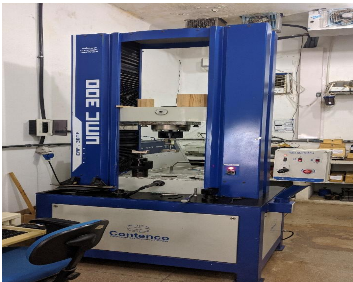
Figura 8 - Máquina universal de ensaios mecânicos, Laboratório de Ensaio Mecânico, DPF/IF/UFRRJ.
