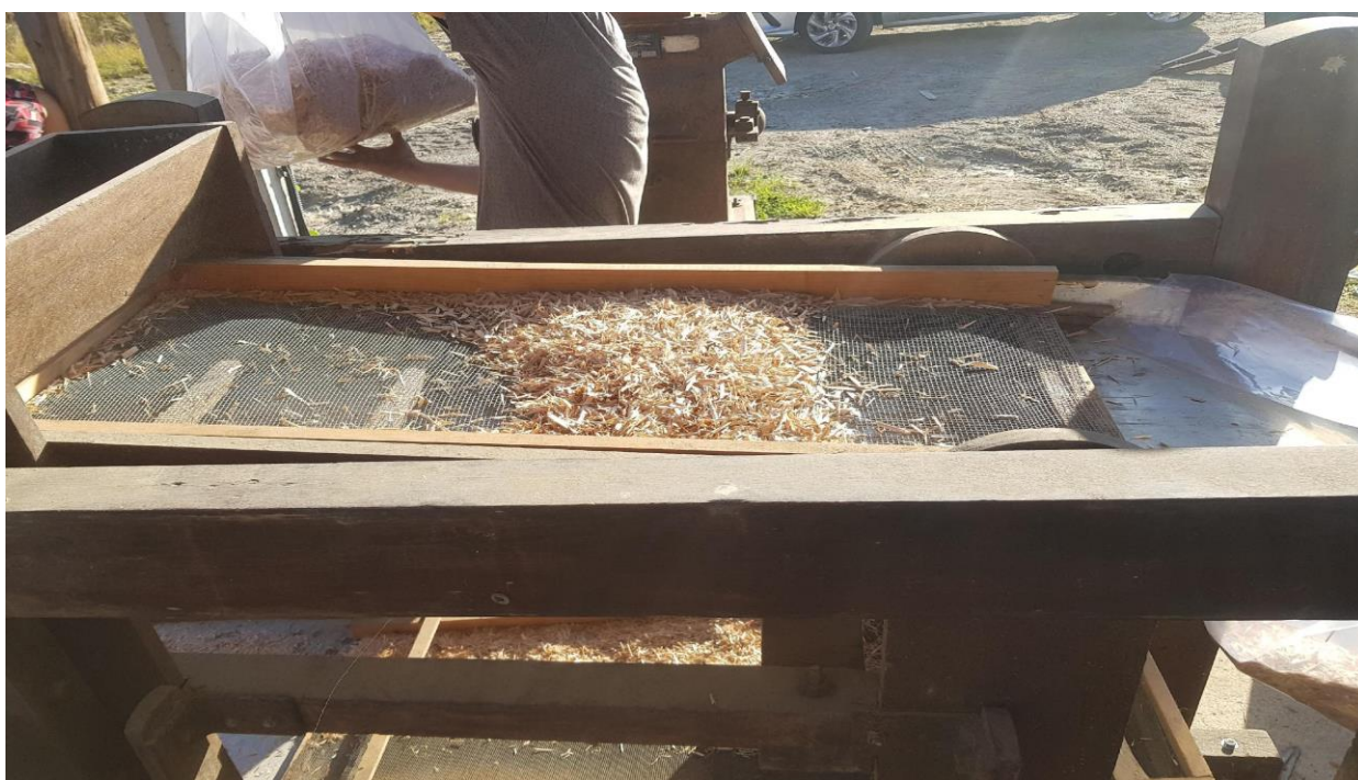
Figura 3 - Peneira mecânica utilizada para dimensionar partículas.
