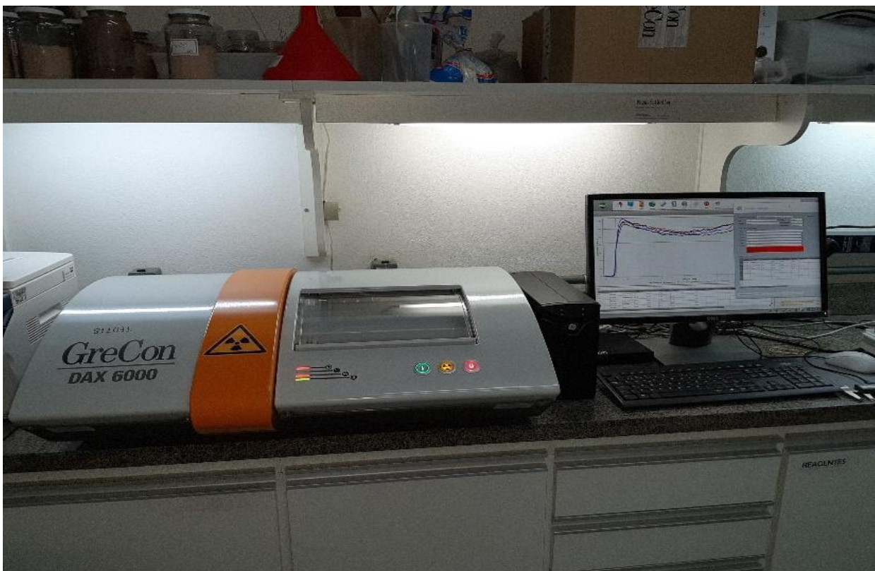
Figura 7 - Densitômetro de raio X do Laboratório de Painéis de Madeira, UFES.
