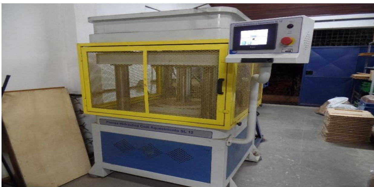
Figura 6 - Prensa termo hidráulica utilizada para fabricar os painéis em altas temperaturas.
