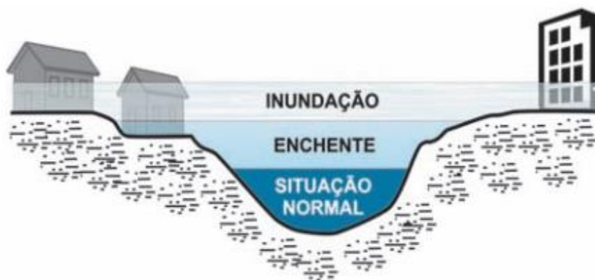
Figura 2: Perfil esquemático do processo de enchente e inundação (MINISTÉRIO DAS CIDADES/IPT, 2007).
