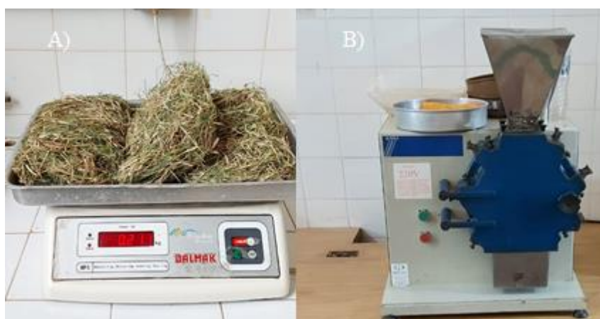
Figura 11. A) Amostras de capim Tifton 85 pesadas após secagem na estufa; B) Moinho Tipo Willey utilizado para moer as amostras de capim Tifton 85.
