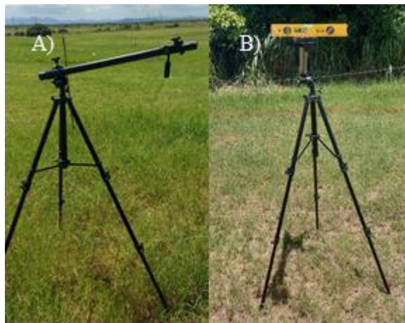
Figura 12. A) Unidade experimental formada pelo tripé, braço articulado e câmera; B) Controle e padronização da coleta das amostras com ajuste lateral e vertical.
