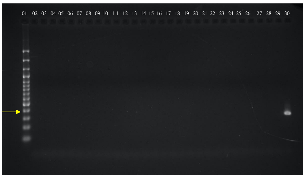
Figura 10. Representação do produto da PCR para o gene dsb (seta amarela: ~349 pb), aplicado em gel de agarose a 2% (UltraPure™ LMP Agarose, Invitrogen®), separado por eletroforese (5V/cm), corado com brometo de etídio e visualizado em transiluminador de Luz UV. Poço 01: Ladder; Poços 2-28: Amostras testes negativas; Poço: 29: Controle negativo; Poço 30: Controle positivo.
