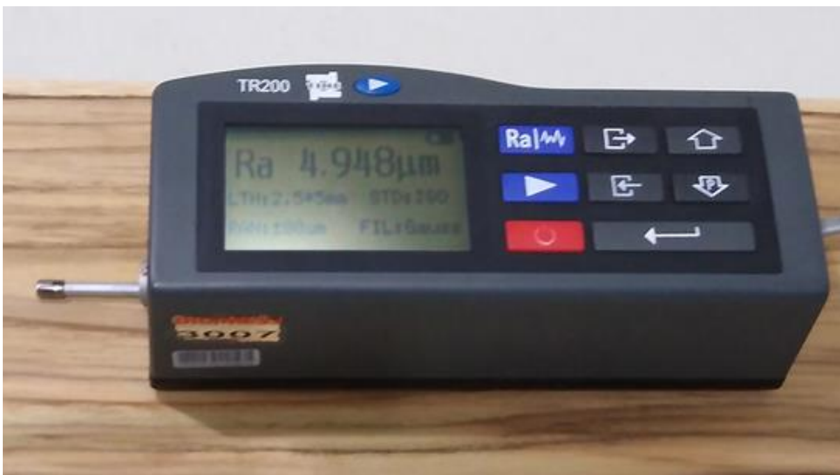
Figura 14. Rugosímetro de arraste Digimess, modelo TR200. Fonte: elaboração do autor.
