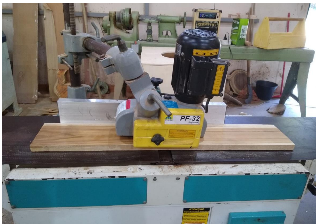
Figura 10. Plaina desempenadeira com o alimentador de avanço. Fonte: elaboração do autor.
