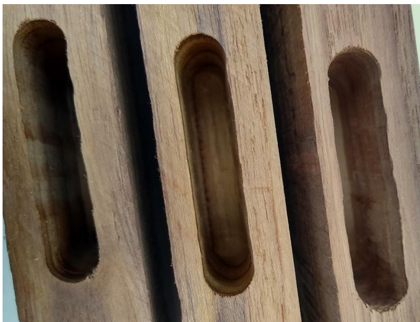
Figura 20. Madeira de teca após furação para encaixe de espiga. Fonte: elaboração do autor.
