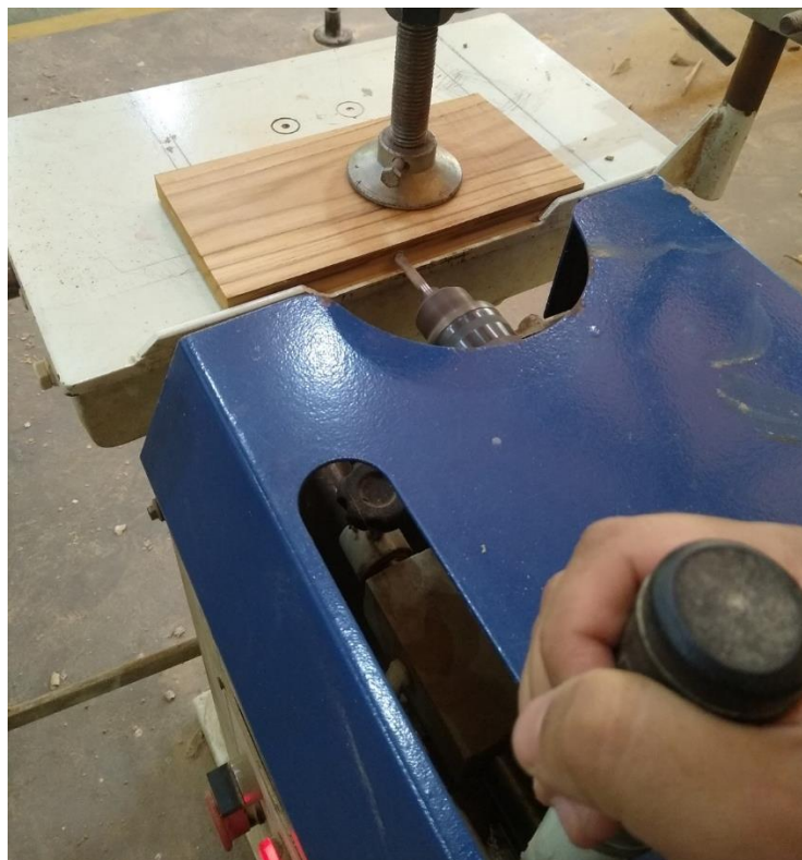
Figura 13. Furadeira horizontal utilizada para a confecção do encaixe de espiga. Fonte: elaboração do autor.
