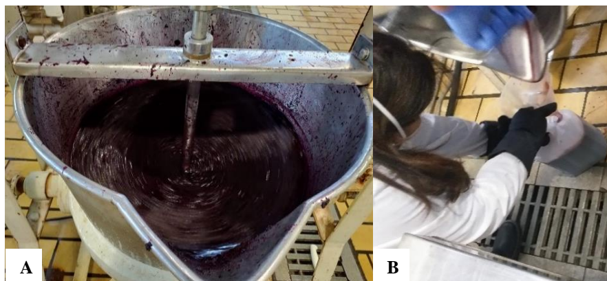
Figura 4. Pasteurização da polpa de juçara: (A) – Polpa em tacho aberto; (B) – Envase da polpa pasteurizada em embalagens de polietileno para prosseguir com o resfriamento em banho de gelo.
