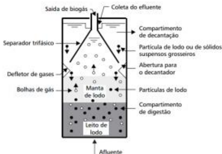
Figura 20 – Esquema do processo de funcionamento do reator UASB
