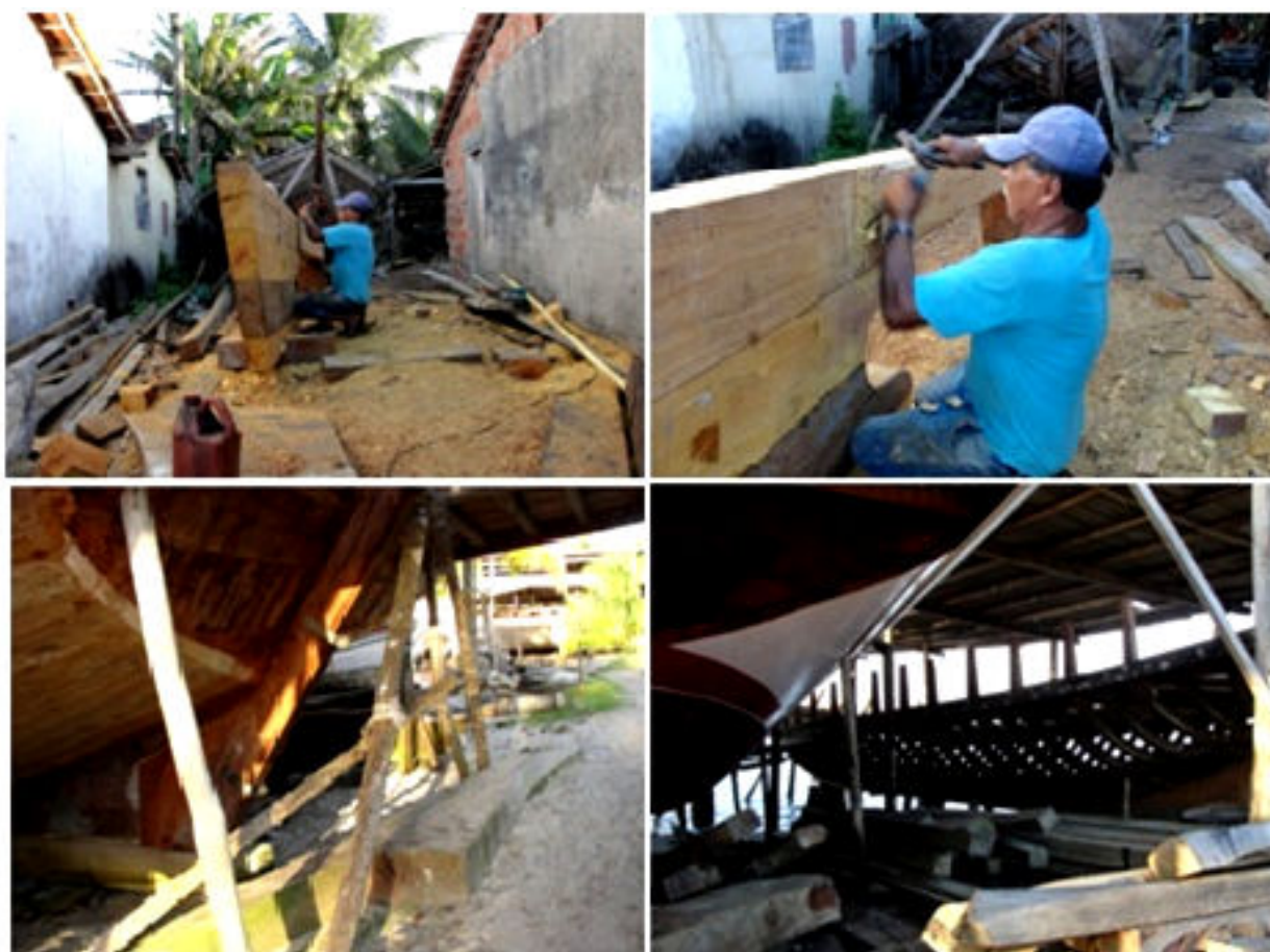
Figura 22 - Etapas da construção de um barco. FONTE: Acervo imagético da autora, julho/2012.
