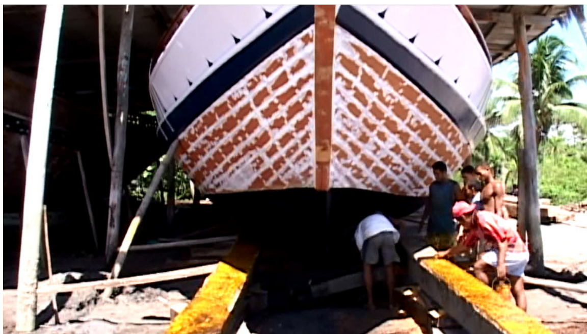
Figura 29 - Preparação da madeira com óleo de dendê, para o barco correr. FONTE: Carpinteiros do Mar (2005).
