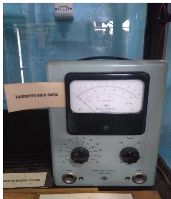
Figura 28. Voltímetro para áudio. Foto: acervo próprio da autora (2023)
