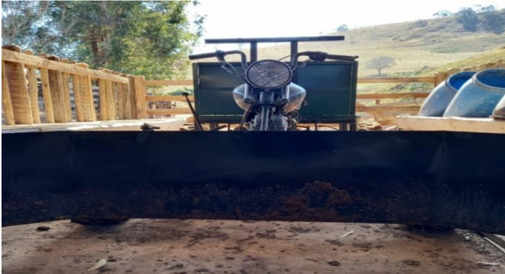
Figura 21. Veículo adaptado construído com motor de moto 125 cc para limpeza e transporte do esterco. Fonte, J. Felipe
