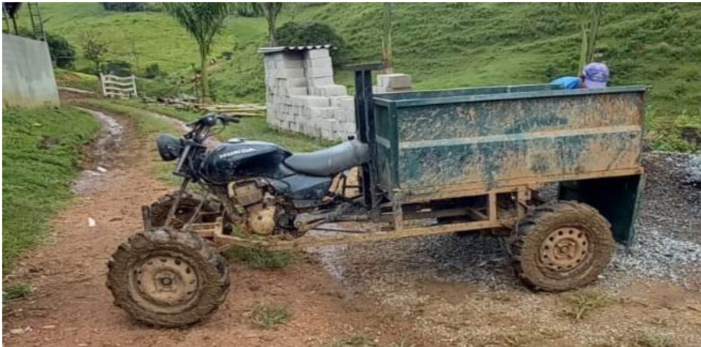
Figura 22. Visão lateral do veículo adaptado que conta com uma caçamba basculante. Fonte, J. Felipe
