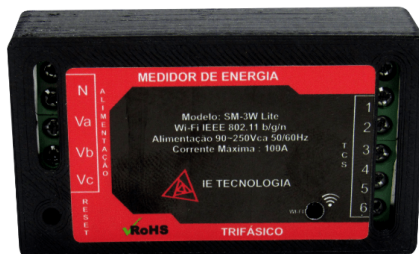
Figura 12. Medidor de energia utilizado para monitoramento dos parâmetros da rede elétrica. Fonte: Manual do usuário SM-3W lite.
