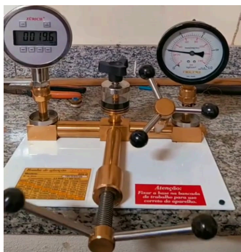
Figura 9. Bomba de aferição utilizada para determinação da curva de calibração do transdutor de pressão. Fonte: Autor.
