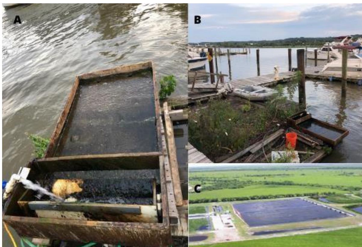
Figura 1: Sistema ATS em funcionamento, sendo A e B localizados na baía de Chesapeake e C a vista aérea do purificador ATS da unidade S-154 usada para limpar a água da chuva de um canal ao norte do lago Okeechobee na Flórida.
