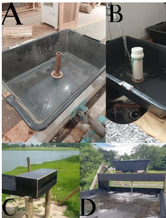
Figura 12: Fotos da construção e instalação do sifão Bell, onde A mostra a construção do sifão, B o teste inicial, C a estrutura de suporte da rampa e D o sifão instalado na rampa 1.
