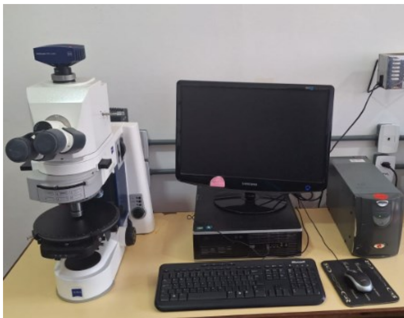
Figura 4. Microscópio ZEISS AXIO utilizado para estudo microscópico de lâminas petrográficas. Fonte: Arquivo pessoal.
