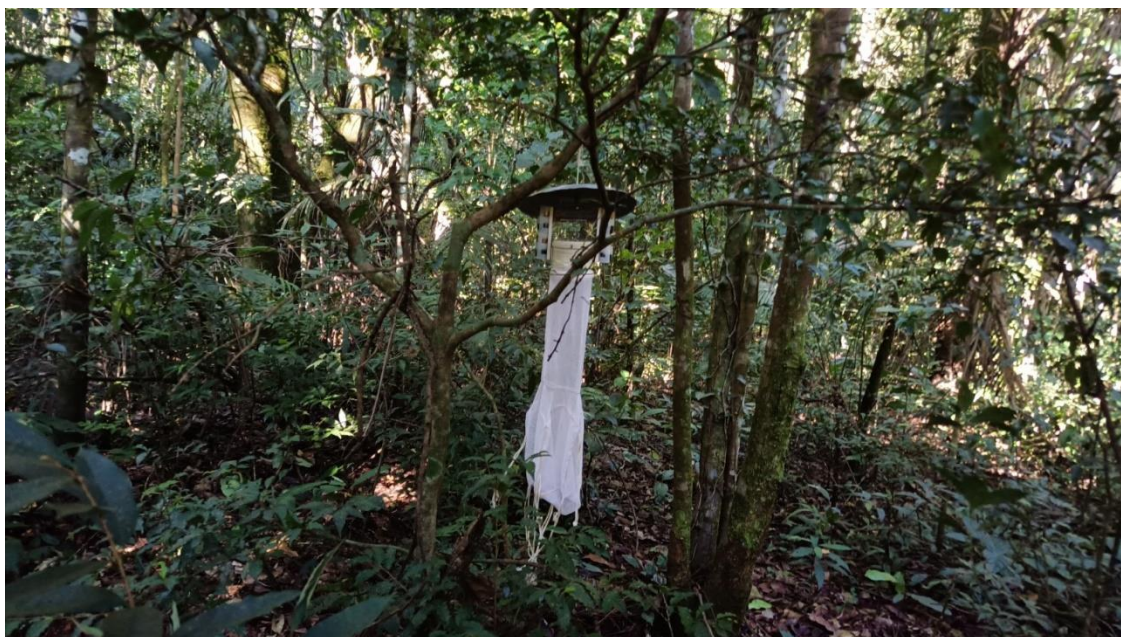
Figura 12. Armadilha luminosa de CDC utilizada na captura dos mosquitos. Fonte: Sérgio Machado.
