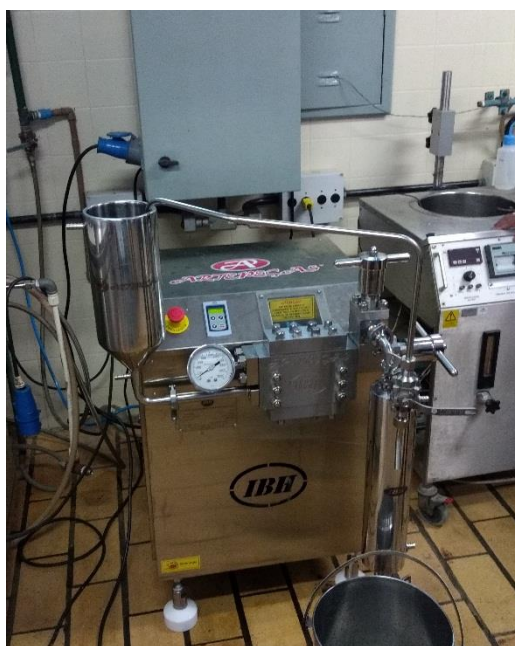
Figura 2 - Homogeneizador a alta pressão Fonte: Próprio Autor, 2019.
