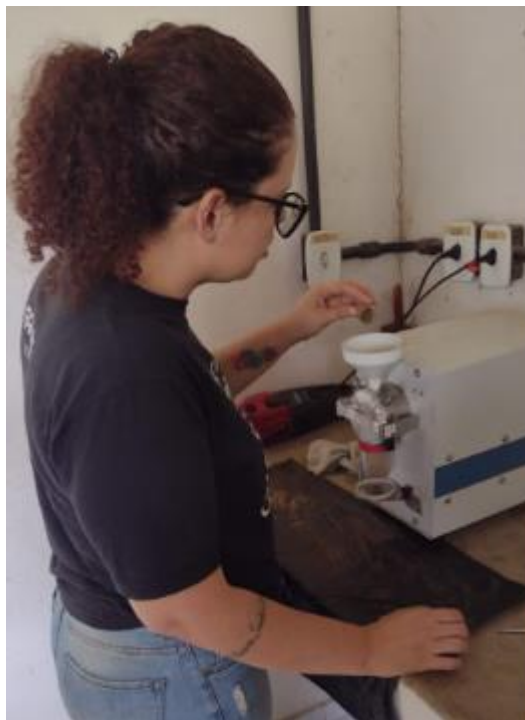
Figura 6. Processo de moagem das amostras de compostagem da Gliricidia para as análises químicas.
