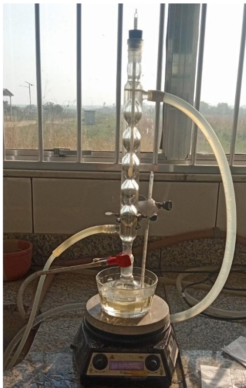
Figura 10: Produção de Biodiesel no Laboratório de Catálise da UFRRJ. Fonte: Autora, 2024.
