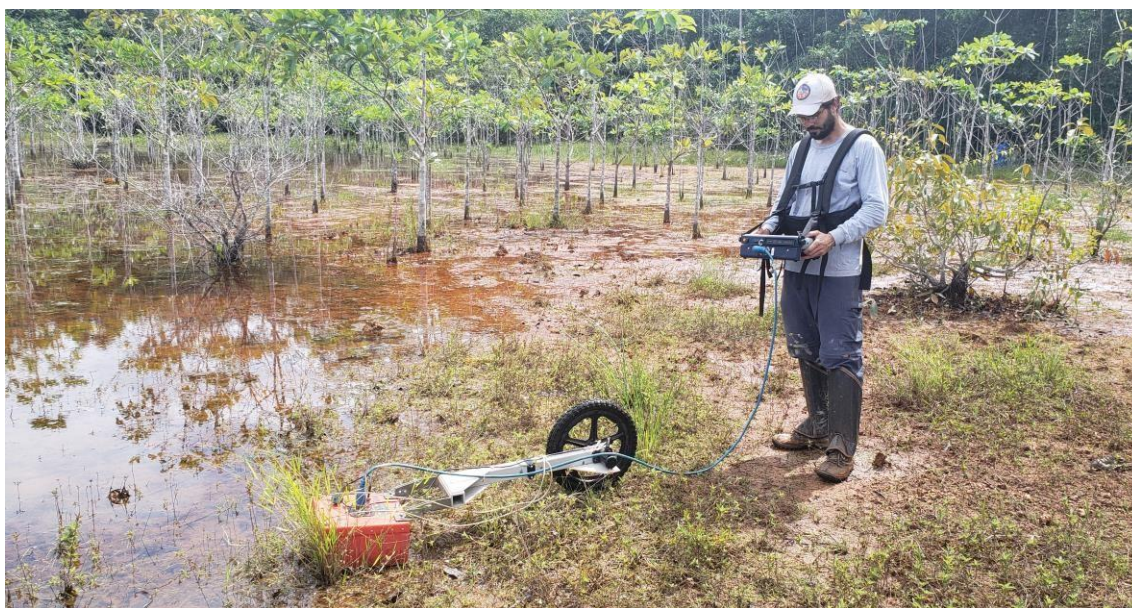
Figura 4. Varredura com GPR em área sujeita a alagamento sazonal.
