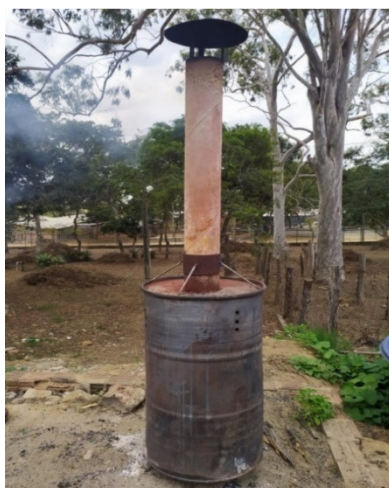
Figura 5. Forno caseiro utilizado para produção dos biochars do Laboratório de Estudos em Microbiologia e Biotecnologia (LEMA) da UFAPE. Foto: Rafaela F. da França.
