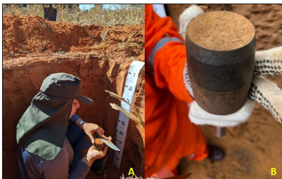
Figura 3. Coleta de amostras indeformadas de terra (A e B).
