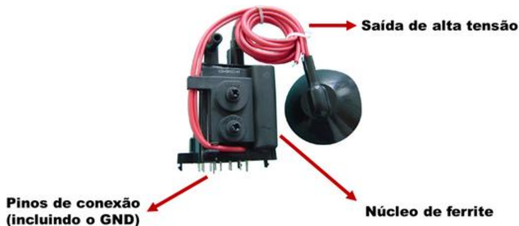
Figura 19: Imagem de um flyback. Fonte: (MUNDIAL COMPONENTES, 2022)
