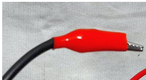
Figura 36: Um dos terminais das bobinas, sendo todos também na forma de conectores garra jacaré.
