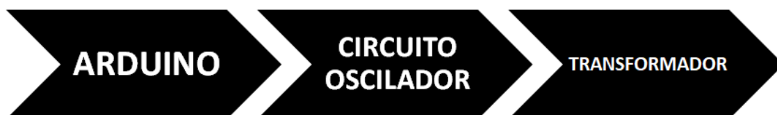
Figura 16: Sequência de acionamento e controle do transformador
