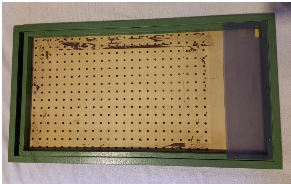
Figura 14. Semeadeira para sementes peletizadas de alface, fabricante Semeart. Foto do autor, 2024.
