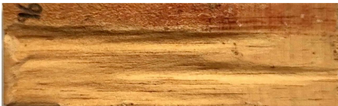
Figura 12. Corpo de prova com ação muito severa, onde o térmita tomou cerca de 50% da amostra.
