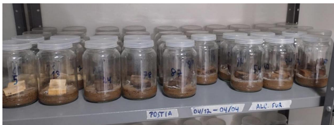
Figura 3. Frascos contendo iniciadores de madeira inoculados com os corpos de prova postos visando a colonização dos mesmos pelo fungo Rhodonía placenta .
