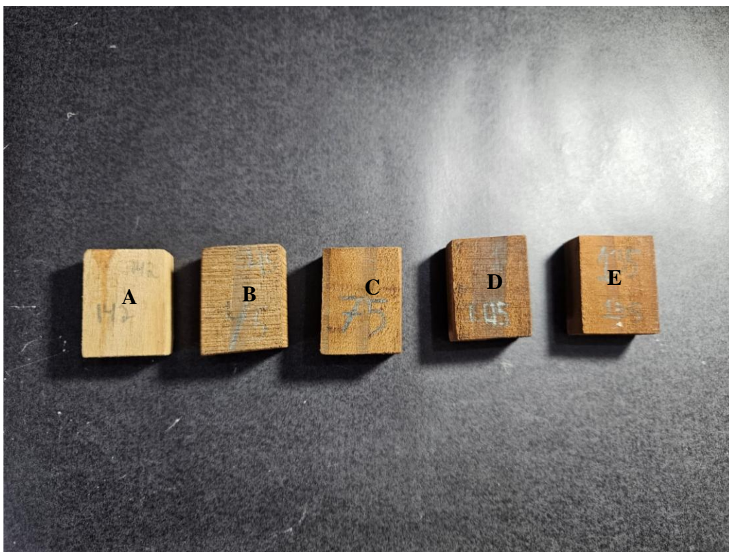
Figura 4. Corpos de prova tratados após a ação do fungo Rhodonia placenta após a secagem em estufa. Da esquerda para a direita: Controle (A), 10 (B), 25 (C), 50 (D) e 100% (E) de álcool furfurílico, respectivamente.
