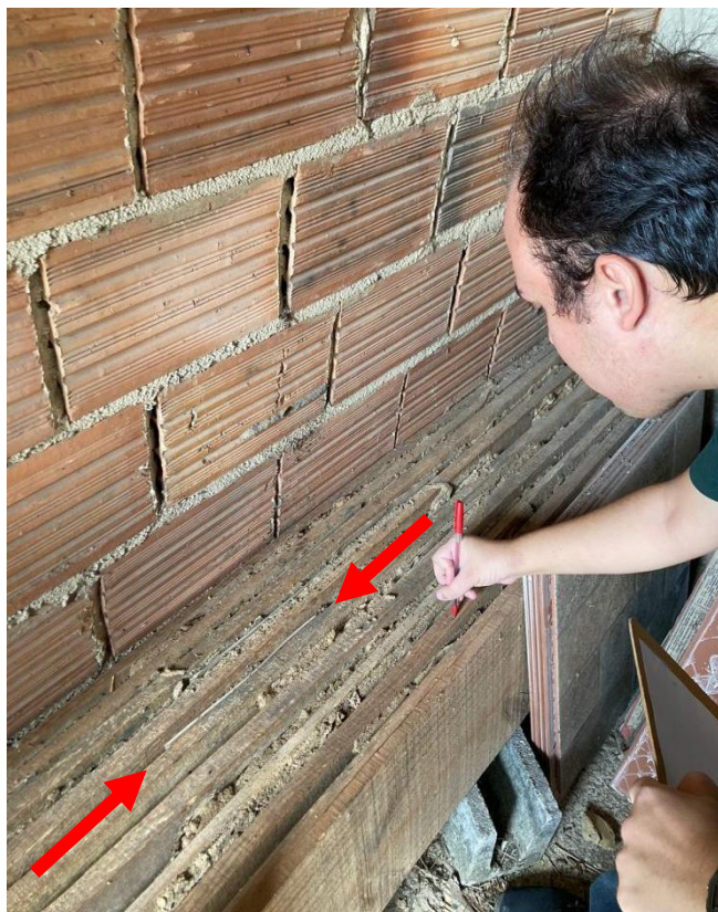
Figura 8. Amostras inseridas na infestação ativa de Coptotermes gestroi . Setas em vermelho indicando o posicionamento do bloco na infestação.
