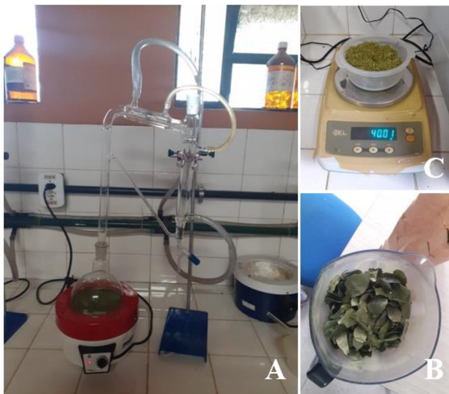
Figura 18. Extração dos OEs de Eugenia uniflora L. (A) Equipamento Clevenger modificado. (B) Liquidificador. (C) Balança centesimal.
