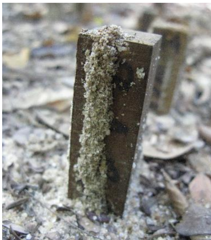
Figura 200. Túnel de térmita subterrâneo em corpo de prova de madeira de Pinus submetida a deterioração em condição de campo por cinco meses.
