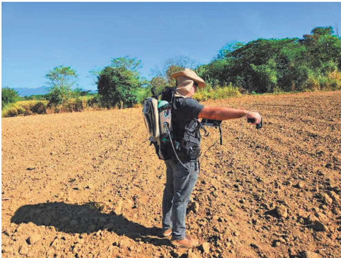
Figura 22: Coleta de dados das amostras de solo com o espectrorradiômetro.
