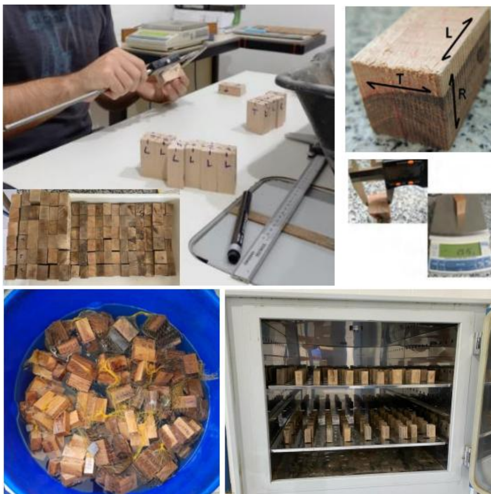
Figura 9: Procedimentos para determinação das propriedades físicas das subamostras. Fonte: arquivo fotográfico LPM/UFRRJ.
