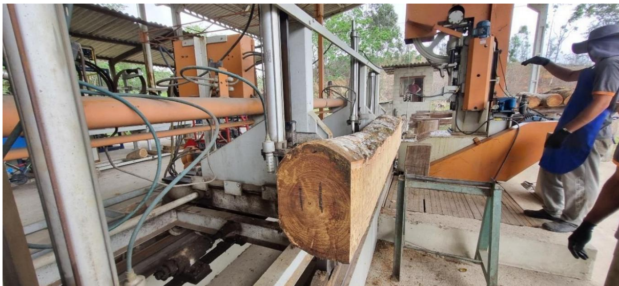
Figura 7: Operação de desdobramento primário em serra de fita vertical Vantec. Fonte: arquivo fotográfico LPM/UFRRJ.
