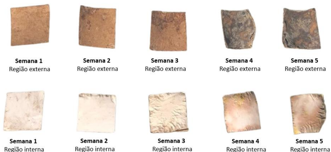
Figura 17 - Teste de biodegradação da embalagem RI-K no período de cinco semanas, indicando a diferença da degradação na região externa e interna.
