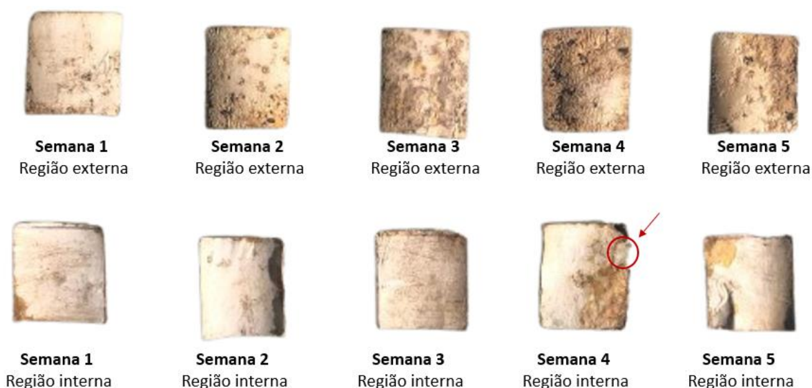
Figura 16 - Teste de biodegradação da embalagem RI-B no período de cinco semanas, indicando a diferença da degradação na região externa e interna.
