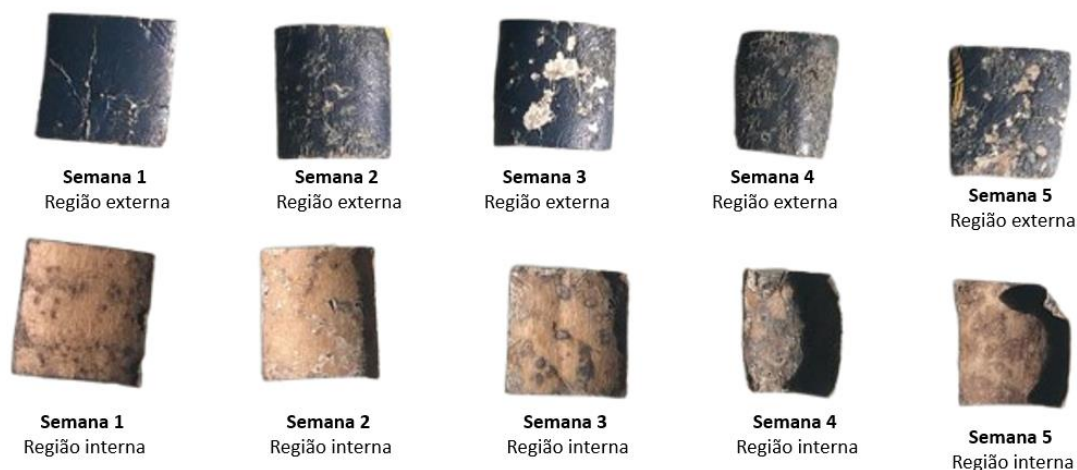
Figura 15 - Teste de biodegradação da embalagem RE-K no período de cinco semanas, indicando a diferença da degradação na região externa e interna.
