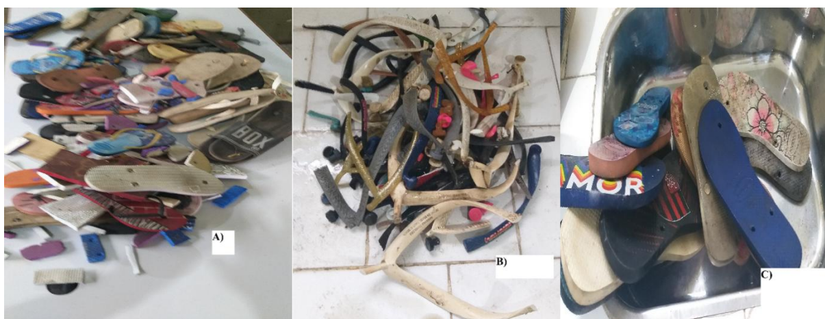
Figura 6. A) sandálias do tipo flip-flop que foram recolhidas pelos coletores; B) Tiras separadas dos solados e C) Material selecionado e higienizado para uso na produção do compósito.
