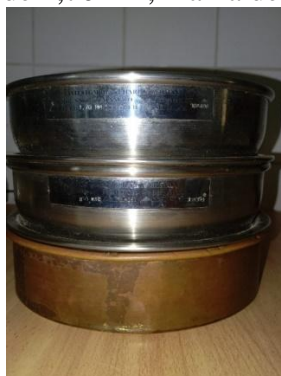
Figura 5. Conjunto de Peneiras ASTM 20 para classificação granulométrica das partículas. De cima para baixo: malha de 1,70mm; malha de 0,85mm e finos (fundo).
