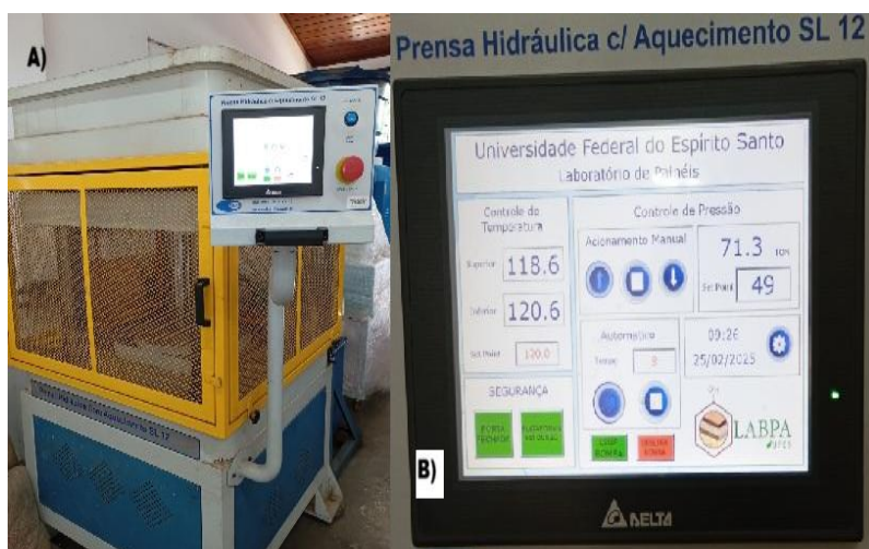
Figura 10. A) Prensa Hidráulica SL-12 e B) Parâmetros de prensagem.
