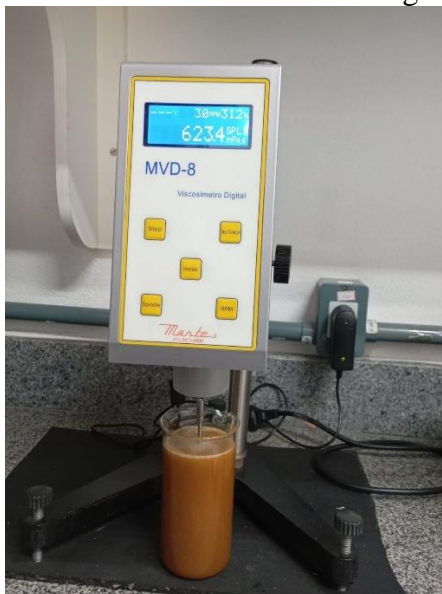
Figura 8. Caracterização da viscosidade com Viscosímetro Digital.
