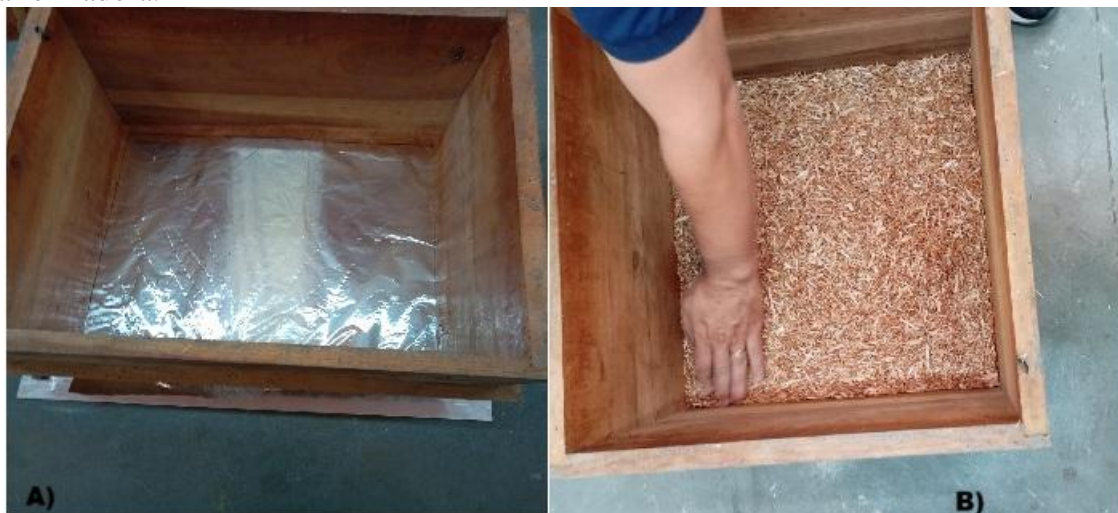
Figura 9. A) Caixa formadora forrada com folha de alumínio e B) Uniformização do material na caixa formadora.
