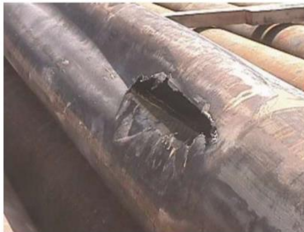
Figura 1.4 Tubulação colapsada no poço Pompano A-31. Fonte: PATTILLO; COCALES; MOREY, 2004.
