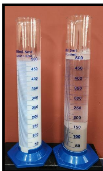
Figura 2.12 Teste de proveta graduada para avaliar a sedimentação com fluidos contendo calcita e barita. Fonte: AUTOR, 2023.
