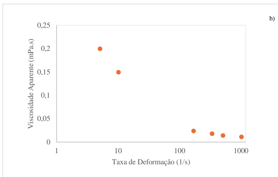
Figura 4.5 Curva de fluxo para a suspensão do fluido complexo com concentração volumétrica com 7% de calcita com presença de goma xantana: a) Dados de tensão de cisalhamento por taxa de deformação; b) Dados de viscosidade por taxa de deformação. Taxa de deformação entre 0,0001 e 1000. Fonte: Autor, 2024.
