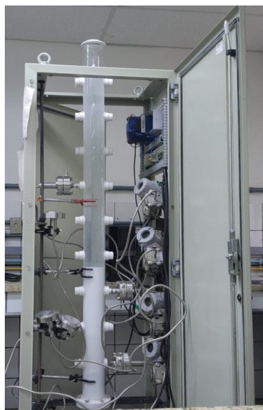
Figura 4.28. Teste de sedimentação com calcita. Presença de fluido turvo e sedimento na base da coluna da Unidade de Bancada II. Fonte: AUTOR, 2024.
