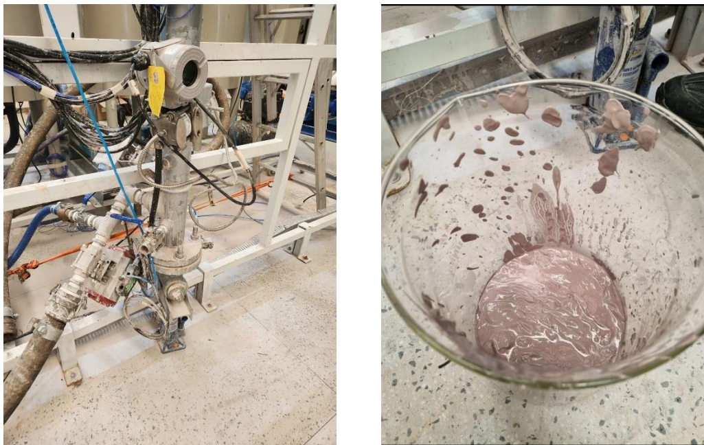
Figura 4.41 Teste de transmissibilidade de pressão: a) válvula de escoamento de fluido localizado na base da coluna; b) resíduo do teste de escoamento. Fonte: AUTOR, 2024.
