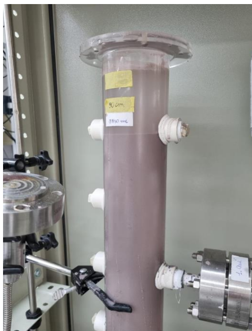
Figura 4.11. Ensaio de sedimentação com barita, evidenciando a presença da frente de sedimentação e da espuma contendo partículas sólidas aderidas. Fonte: Autor: 2023.
