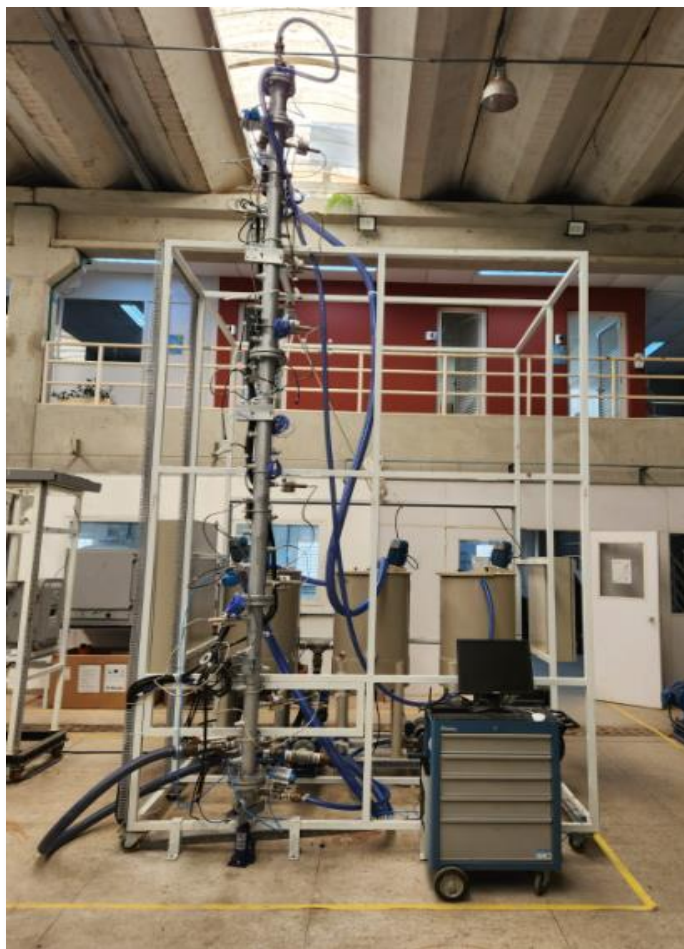
Figura 3.5 Unidade Piloto de Monitoramento da Concentração de Sólidos. Fonte: AUTOR, 2023.
