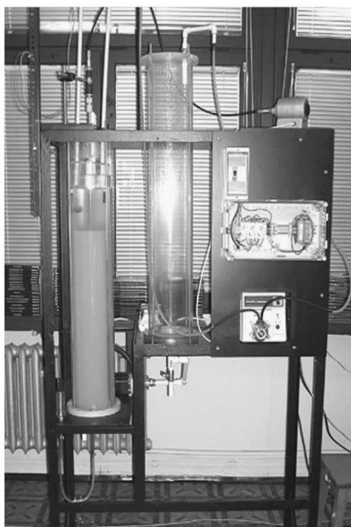
Figura 2.16 Planta piloto de sedimentação em batelada projetada e operada no Instituto de Controle Automático. Fonte: NOCÓN 2010.
